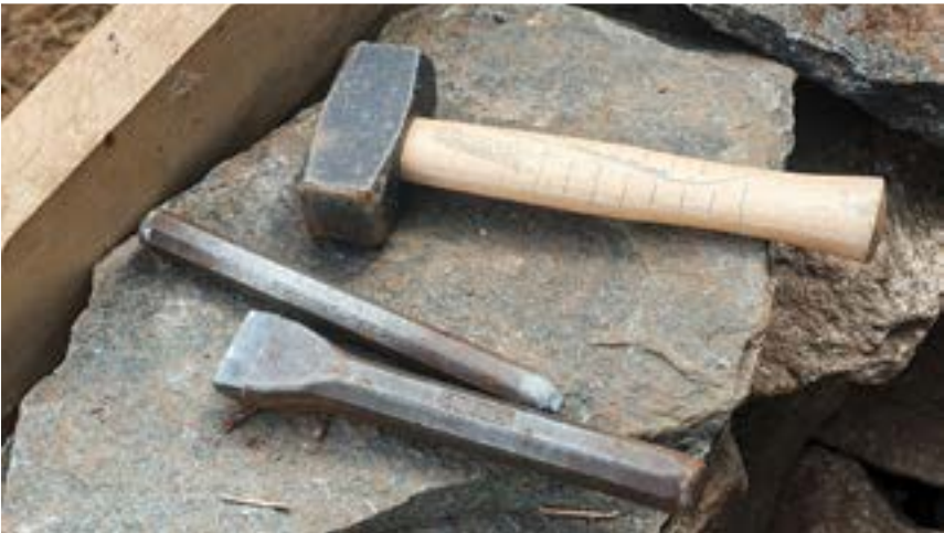
Pour casser et façonner de la pierre naturelle, il faut un outillage adapté. Il varie en fonction du type de pierre. Ici une massette, un coin et une chasse (de haut en bas).
