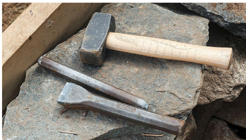
Das Spalten und das Bearbeiten von Naturstein erfordern besonderes Werkzeug, das je nach Art des Gesteins verschieden sein kann. Hier Fäustel, Preller und Setzer (von oben).
